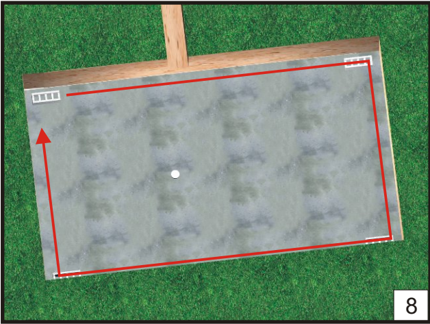
Commencez par un angle et faites le tour sans oublier les blocs pleins à chaque angles.
