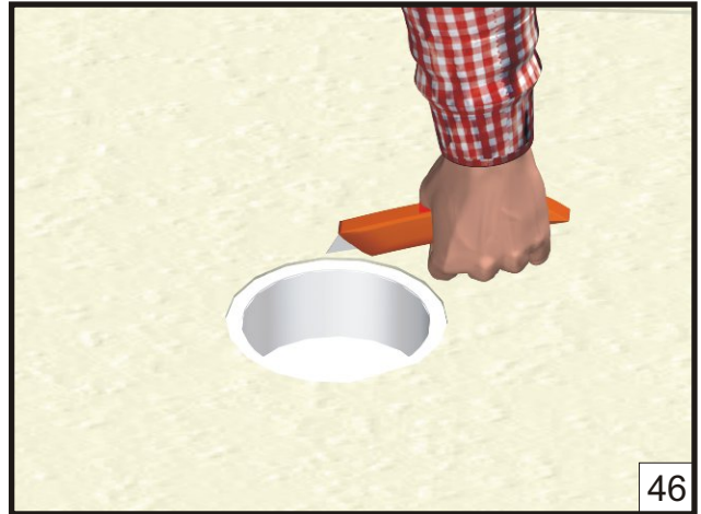
46 Découpez l'emplacement des pièces à sceller. Les découpes doivent se faire en périphérie de la pièce.
